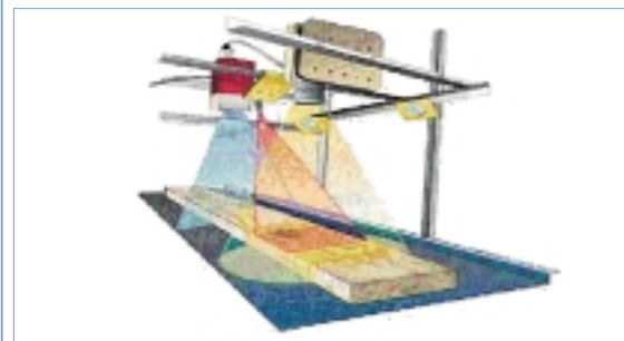
Figura 19 - Sistema di rilevazione difetti su tavole
