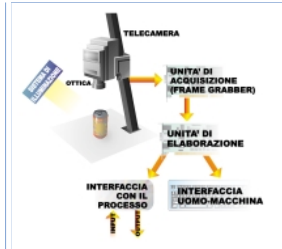
Figura 1 - Schema funzionale di un SdV.
