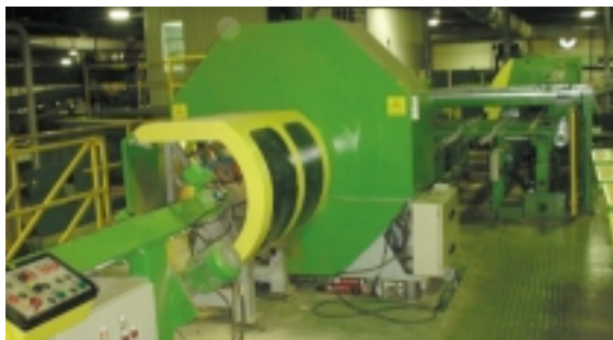
Figura 18 - Scanner a raggi X per tavole - Eyetech machine
