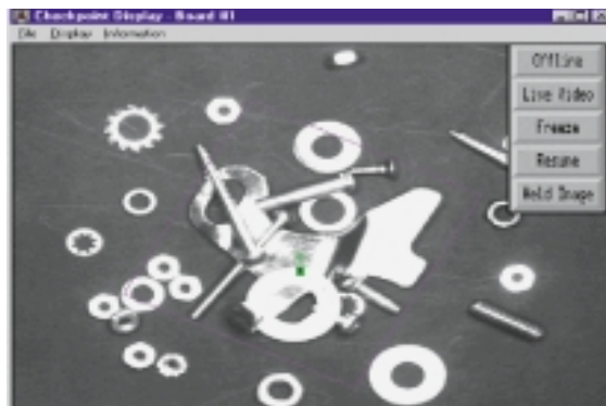
Figura 7 - Riconoscimento di forme precedentemente memorizzate
