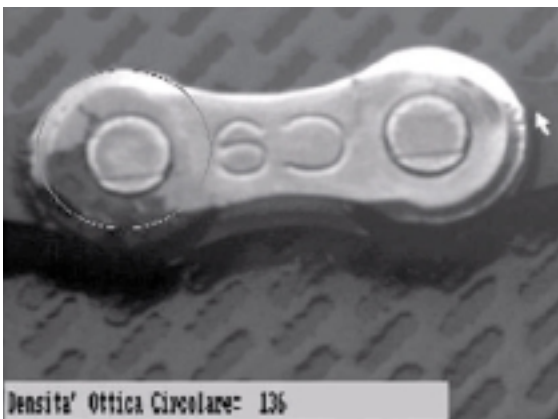
Figura 4 - Controllo di qualità sulla superficie anello di catena di bicicletta - Eidon
