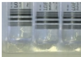
Figura 3 - Lettura di codici a barre su fiale - Eidon
